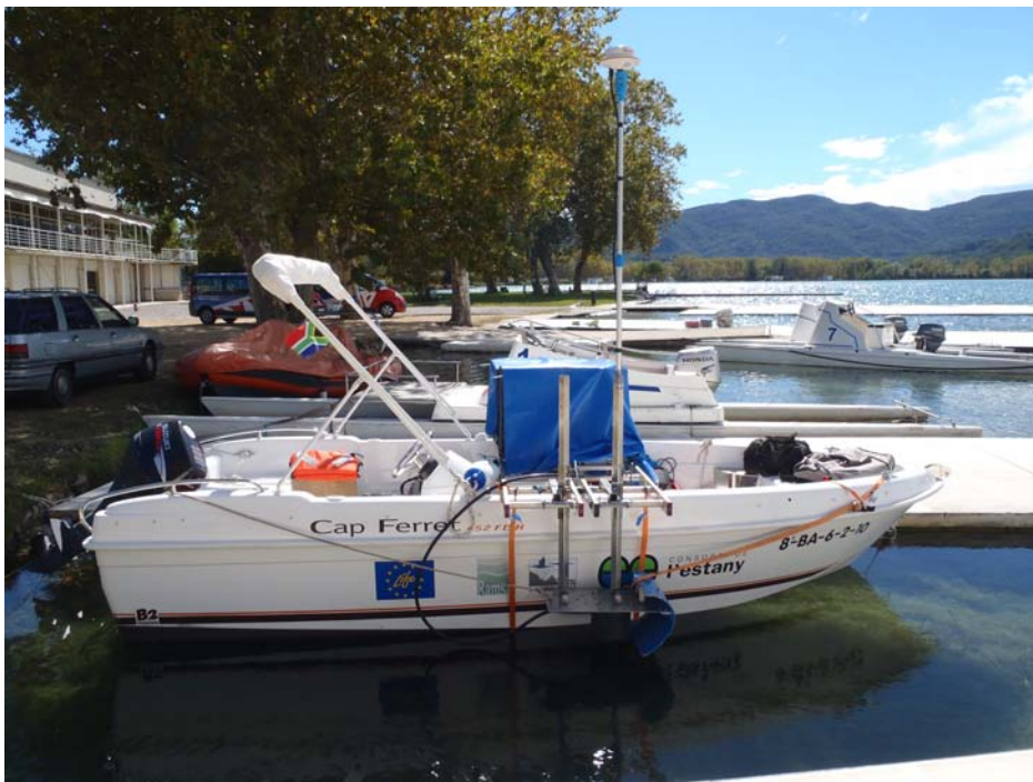
Figura 3: Aspecto de la instalación de la ecosonda y del GPS.
