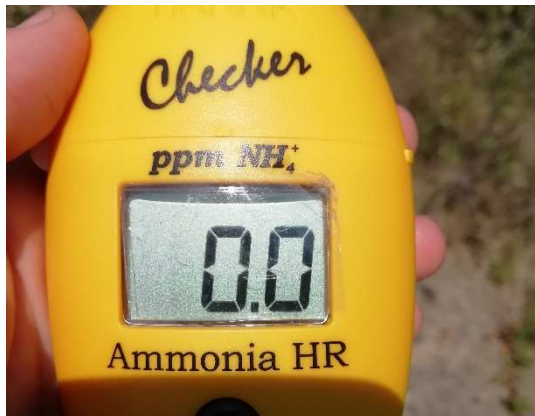
Medición in situ del amonio. Valor por debajo del umbral de referencia (0,4 mg/L).
