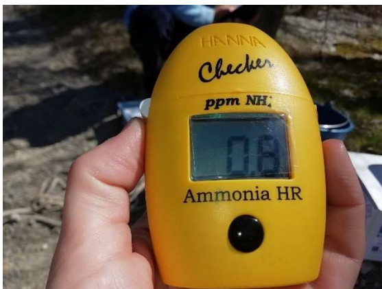
Medición in situ del amonio, aguas abajo vertido de Bodegas Pirineos.
