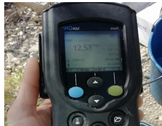
Medición del Oxígeno disuelto con sonda multiparamétrica.
