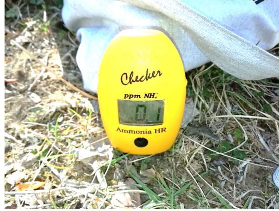
Medición in situ del amonio. Valor por debajo del umbral de referencia (0,4 mg/L).
