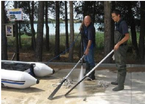
Figura 5. Proceso de desinfección de embarcación y equipos de muestreo
