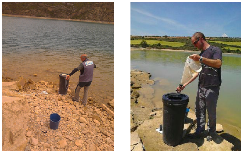
Figura 3. Toma de muestra en superficie
