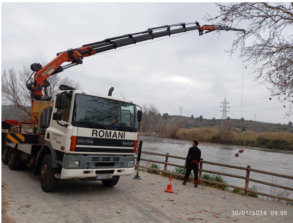
Figura 13. Camión con pluma de 25 m situando la sonda Helley Smith.
